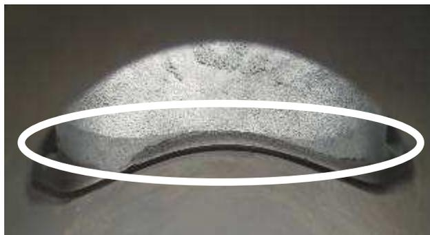
5.9 La hauteur d'échappement (distance entre le haut du cylindre et le haut de la lumière d'échappement) doit être vérifiée à l'aide du gabarit ROTAX(PMFR421.022)
