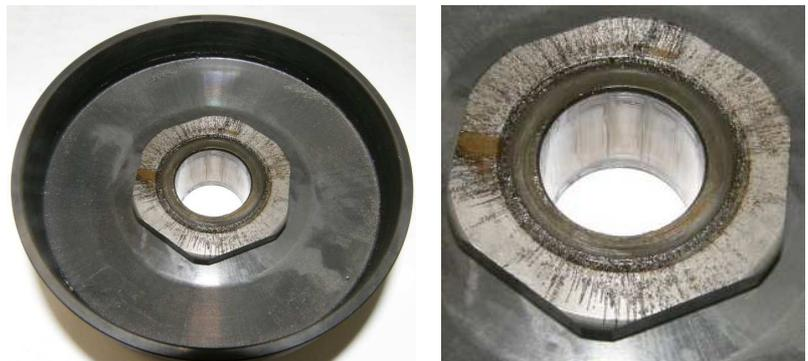
Les photos montrent le maximum de dépôt de graisse pouvant être centrifugé dans la cloche même avec le joint de cloche d'embayage monté.
