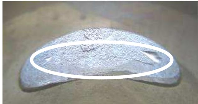
ou peut présenter quelques traces d'usinage ajoutées d'un meulage manuel fait par le fabriquant.
