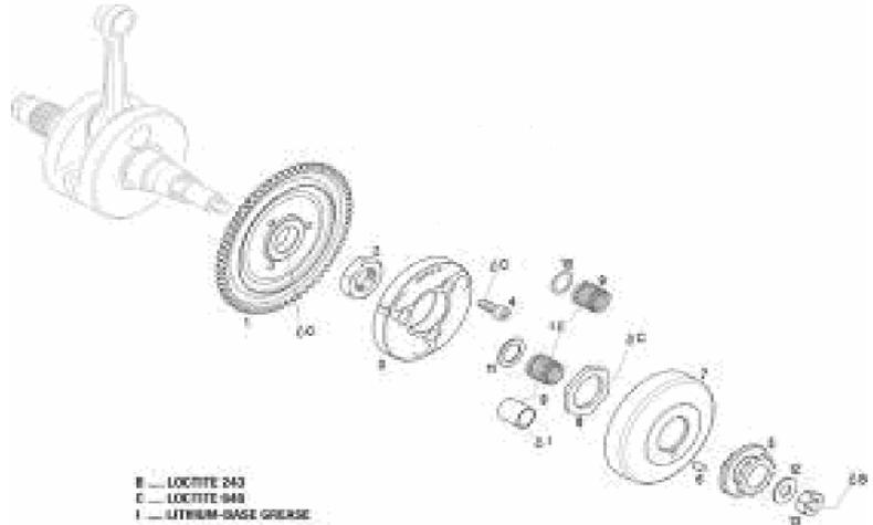
Les moteurs doivent être montés avec la nouvelle cage à aiguille (repère 9) et du joint de cloche d'embayage (repère 10).
