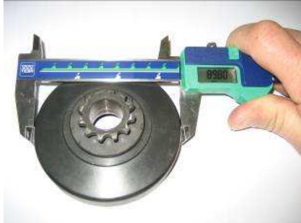
Le diamètre doit être mesuré avec un pied à coulisse positionné en appui sur la cloche (et non à la verticale de la cloche).
