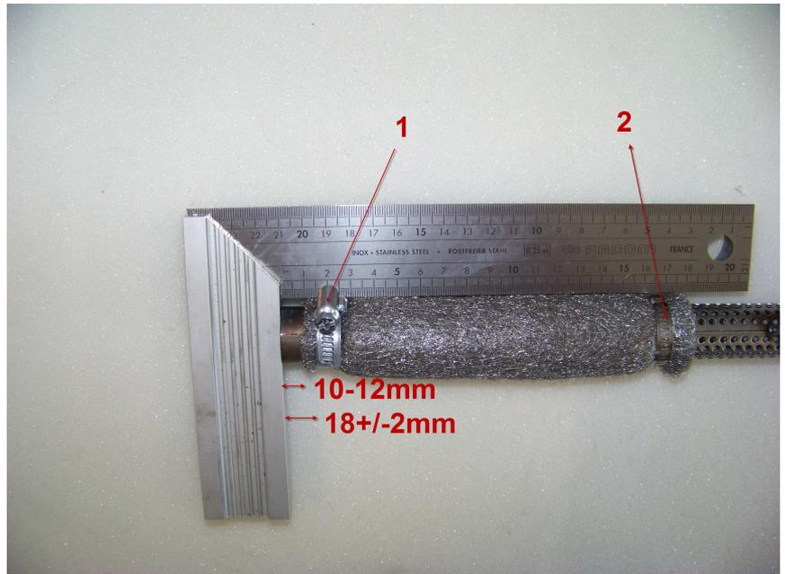
Le collier N°1 doit être fixé à une distance de 18mm +/-2mm (mesure depuis l'extrémité du tube).
