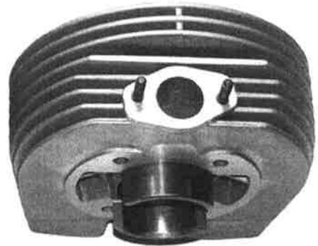
Ailette usinée au-dessus de l'admission
